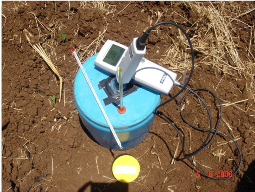
ภาพที่ 3 การวัดการปลดปล่อยก๊าซ CO 2 จากดิน โดย Portable CO 2 analyzer จาก Closed static chamber ในแปลงทดลอง
